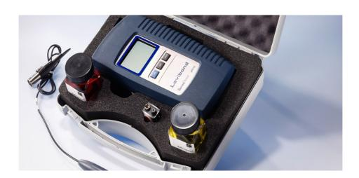
Das SensoDirect Salt110 ist ein portables, zuverlässiges Messgerät mit einer separaten Elektrode zur Salzgehaltbestimmung. Der Messbereich des Salz Testers geht von 0 bis 10 % Salz (Masse-%). Das Gerät verfügt über ein automatische Temperaturkompensation. Das SensoDirect Salt110 ist einfach zu bedienen und besitzt eine Schutzarmierung mit integriertem Elektrodenhalter. Lieferumfang: Gerät Salt110, Batterie, Elektrode, im Koffer mit Anleitung und Garantieerklärung
